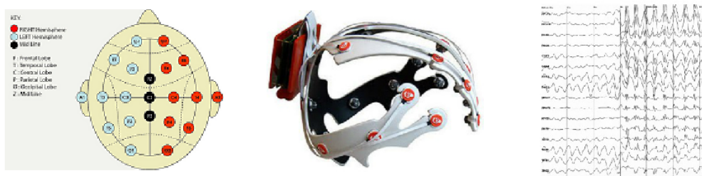
FIGURE 1 – Interface cerveau machine par EEG : Un casque (au centre) permet de capturer en quelques dizaines d'emplacements du crâne (à gauche) des signaux d'activité cérébrale (à droite).
